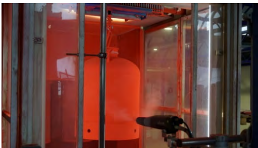
роботизированная окраска баллонов и коллекторов
